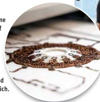
Der Exopulse Suit von Ottobock lindert bei neurologischen Erkrankungen spastische Verspannungen durch gezielte Stimulation.
